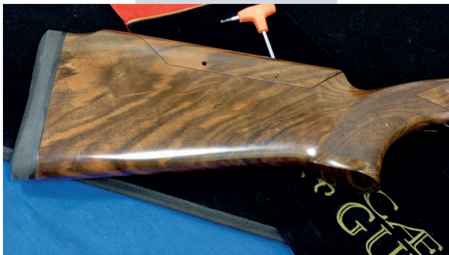
Il calcio con Montecarlo (regolabile DTS) è in legno di noce selezionato e finito ad olio; il calciolo è in gomma piena
